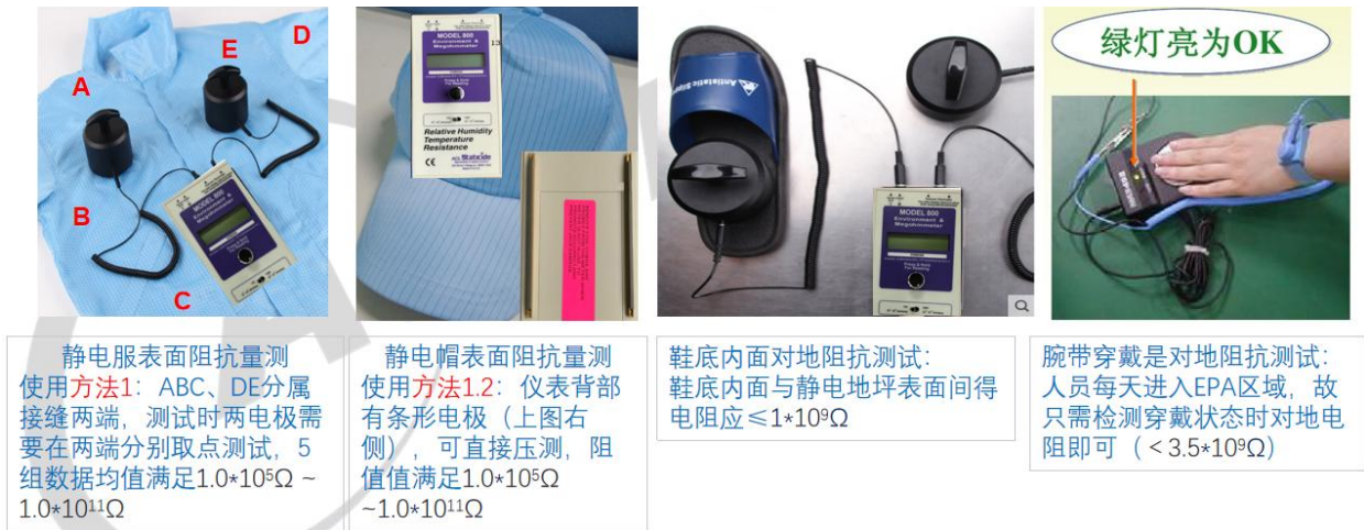
图 3-8 穿戴类表面电阻测试方法
