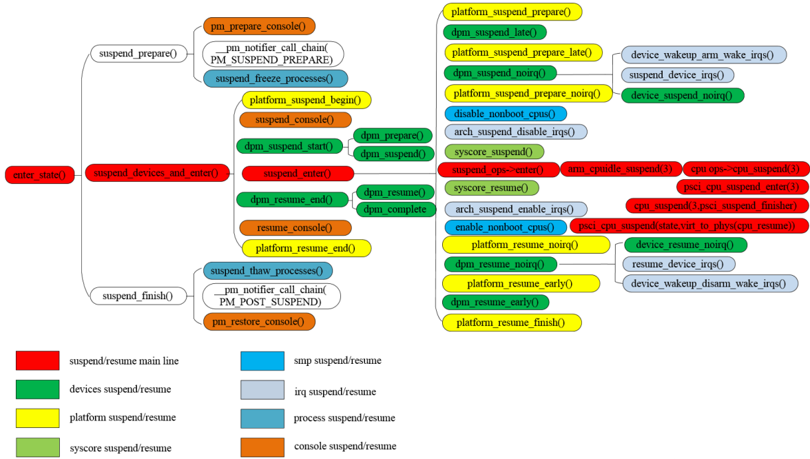
图 2-2: linux standby 流程
