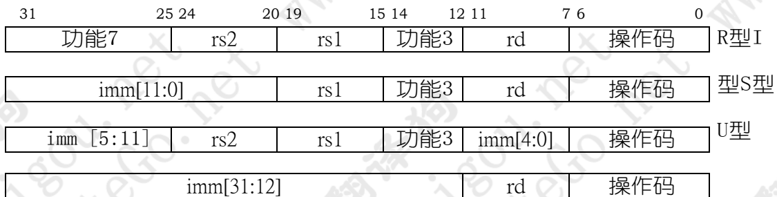
图2.2: RISC-V基本指令格式。每个立即子字段都标有正在生成的立即值中的位位置 (imm [x]), 而不是通常所做的指令立即字段中的位位置。
