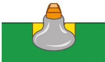
▲ 图1-13：一个焊接好的排针
