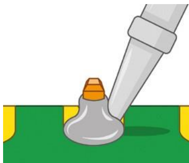
▲ 图1-12：现在移除电烙铁
