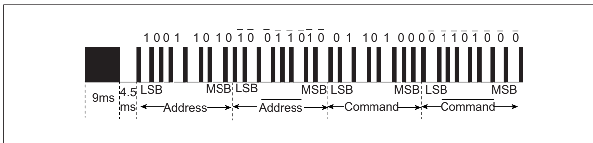
图 8.2: NEC 协议波形
