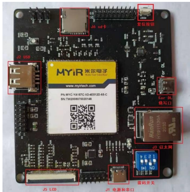
图 1 AHL-STM32MP157 开发板实物图
