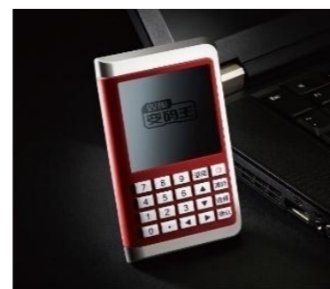
支付密码器 ACL16, 主频48MHz 16KB SRAM, 320KB Flash 国密二级认证
