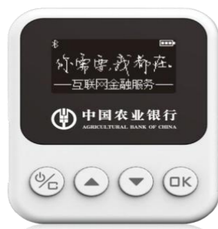
网银U盾 ACL16, 主频48MHz 16KB SRAM, 320KB Flash 集成SM1/2/3/4国密算法
